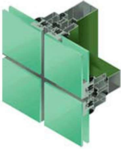
Strüktürel Silikon Cephe Detayı
